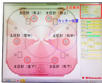
写真-3 土圧分布監視モニター
