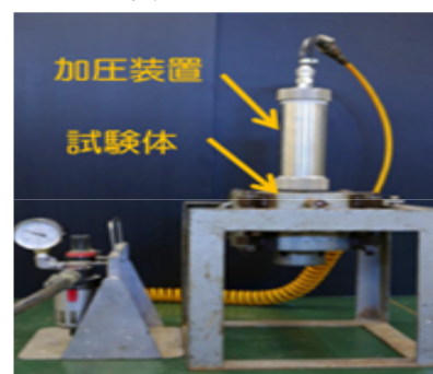
写真-6 防水性確認実験
