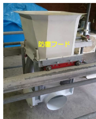
写真-13 自動吹付装置(開発中)
