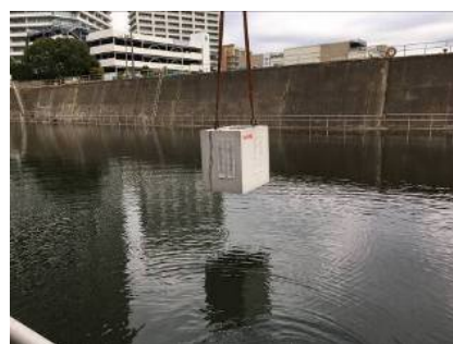
試験体設置状況
