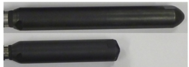
写真-2 従来型バイブレータ（上）及びかる楽バイブレータ（下）
