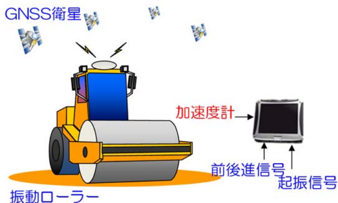
図-6 締固め管理システムとその実施状況
