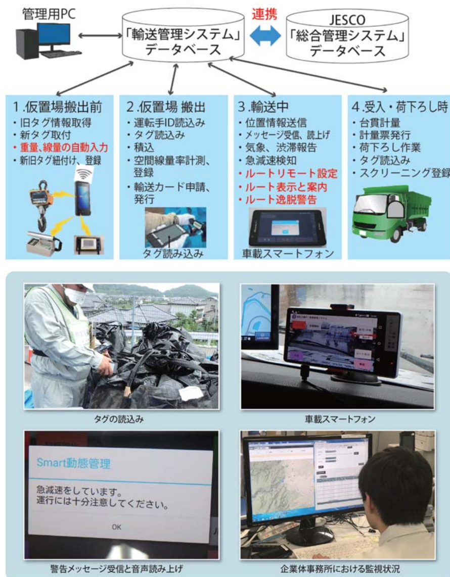
図-2 輸送管理システム（シミズFITシステム）の運用フローと運用状況
