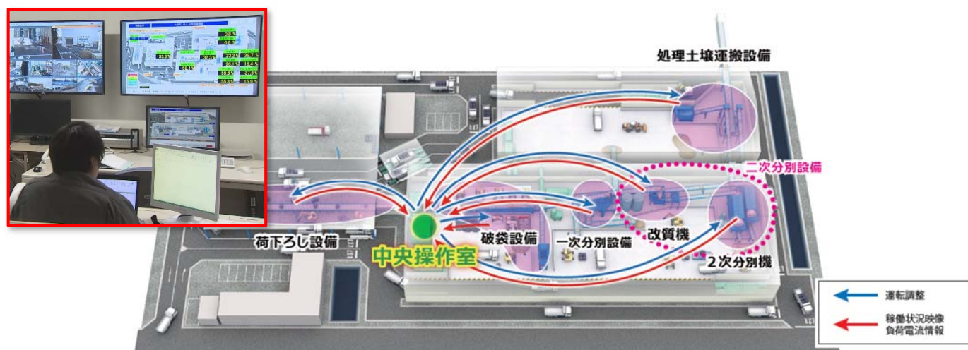
図-3 受入・分別施設の中央制御イメージと中央操作室の運用状況
