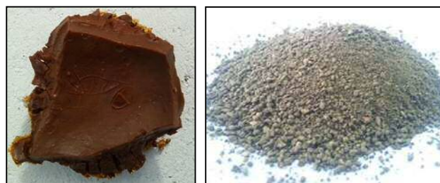
(乾燥前) (乾燥後) 写真－1 鉄バクテリア汚泥の外観
