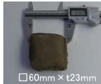
写真－1 脱水固化碎石 5)
