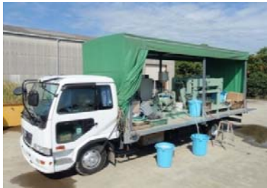
写真-2 高圧フィルタープレス試験機
