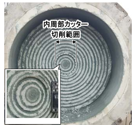
図-5 切削完了後の模擬地盤
