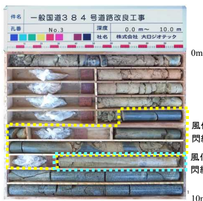
写真-3 到達側坑口の追加ボーリングのコア写真
