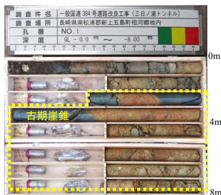
写真-1 発進側坑口の追加ボーリングのコア写真
