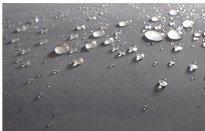
写真-2 型枠塗布施工表面状況
