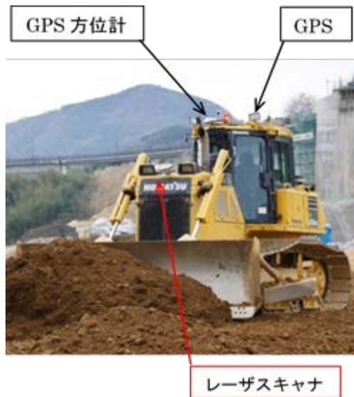
写真-3 自動ブルドーザの外観
