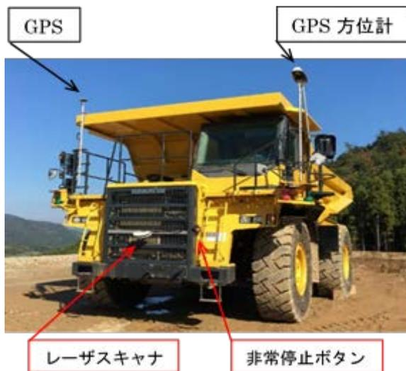
写真-6 自動ダンプトラック (55t) の外観
