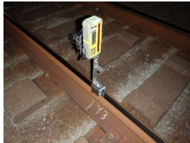
写真-9 軌道計測(センサ受信機)
