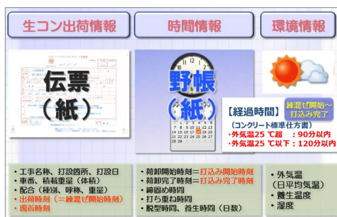
図-4 現場打ちコンクリート工事の管理情報
