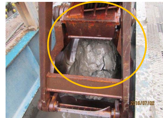
写真-4 刃先下に付着していた粘土土塊
