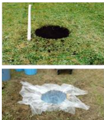
(a) 測定した掘削孔
