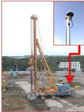
図-6 GNSS 受信機取り付け状況
