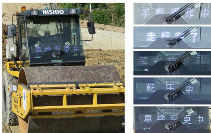
写真-6 車載 LED のステータス表示
