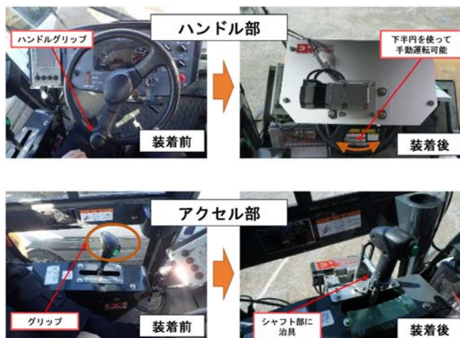
写真-9 外付けロボット機構
