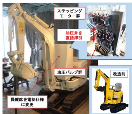
写真-8 遠隔仕様専用機となった例
