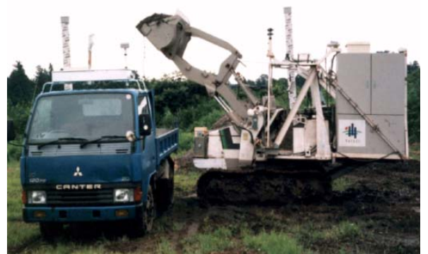
写真-2 自律制御型トラクターショベル
