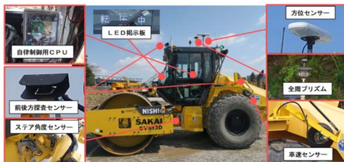
写真-4 機体とセンサー類構成図
