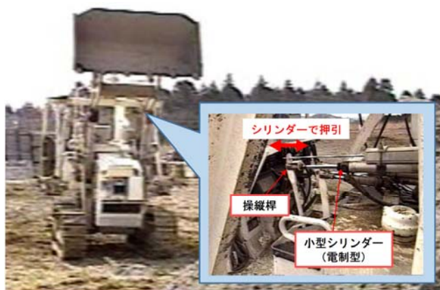
写真-7 当初の制御機構
