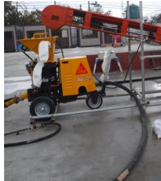
写真-2 吹付け機
