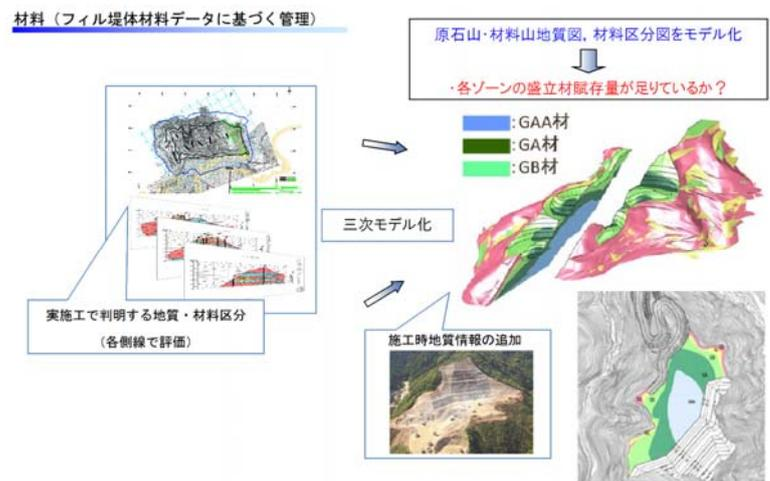
図-3 地質 3 次元モデルイメージ図 (原石山地質図)
