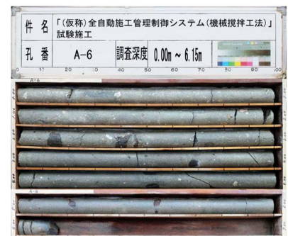
写真-3 Type-3 ラップ杭の斜めボーリングによるコア
