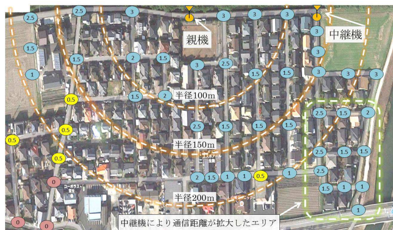
図-10 中継機を使用した住宅地での無線伝搬テスト
