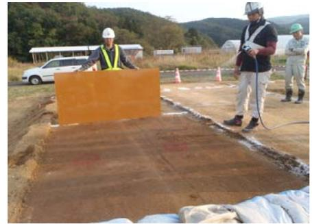
図-8 試験盛土への散水
