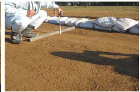
図-11 車両走行による轍(新規改質材)
