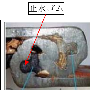
図5 遮水専用鋼矢板継手部(爪部)
