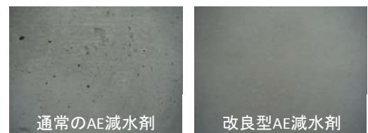
写真-3 コンクリートの表面状況
