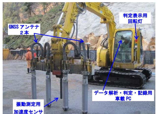
図-15 バイバック及び締固め管理システム全景
