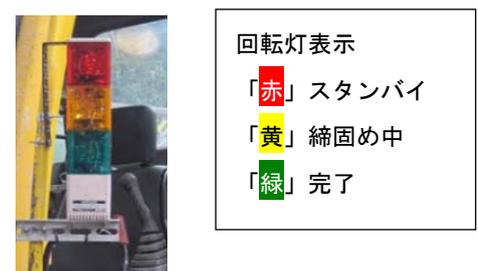
図-16 締固め状況の表示（回転灯）
