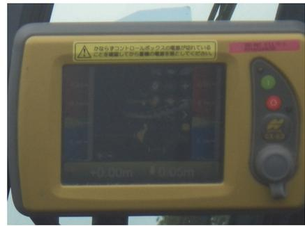
写真 4-2 操縦席内補助モニター (コントロールボックス)
