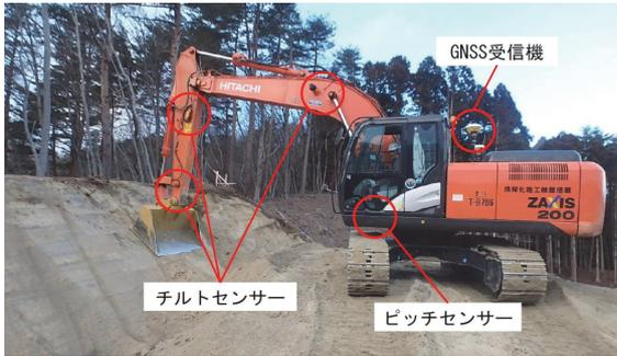
写真 4-1 バックホウ MG システム
