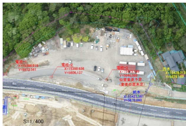
図-3 平面位置の測量例
