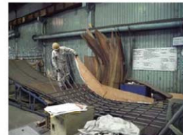
図-11 ユニット鉄筋 工場製作状況 1)
