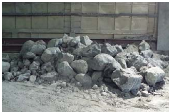
写真-3 硬質玉石 (上り線沢部通過時)
