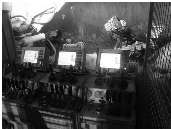
写真-8 大船渡側工区ドリルジャンボ(トンネルナビゲーションシステム搭載)
