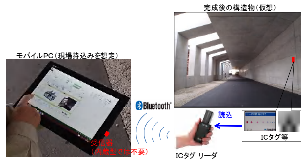
図-6 ICタグを活用した実構造物とC I Mモデルの連携イメージ
