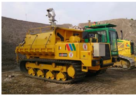
写真-6 高圧洗浄車
