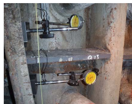
写真-2 変位計測状況
