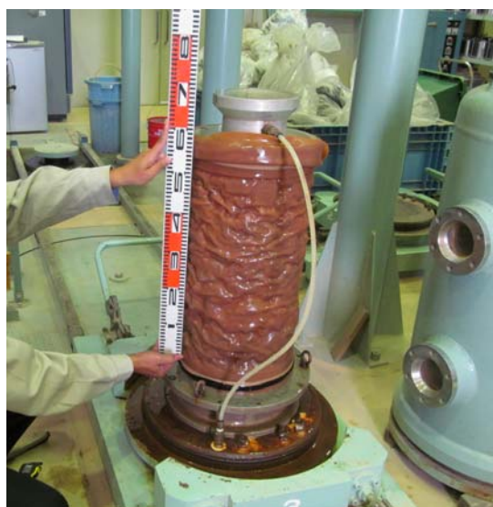
写真 5 三軸圧縮試験後の状況
