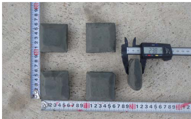
写真3 脱水固化処理土の形状
