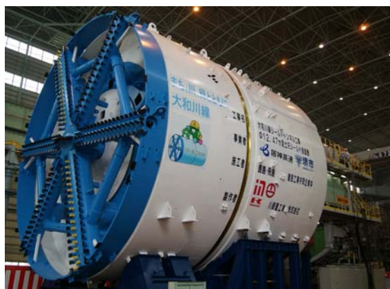
写真－１ シールドマシン
