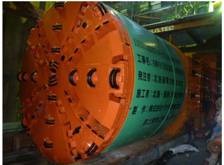
写真1 発進前の掘進機全景
