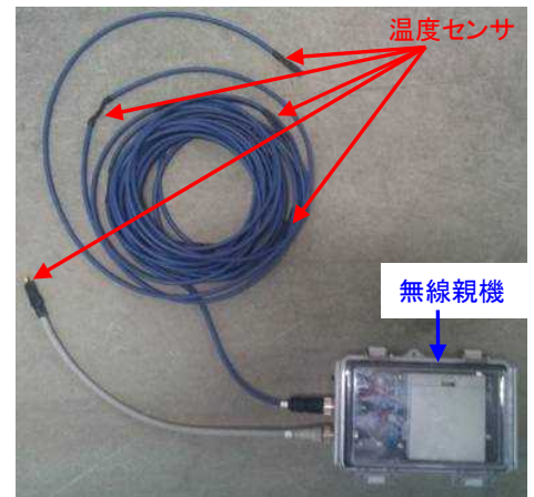
写真-4 1 線多点式無線通信型温度センサ
