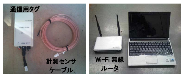
写真-1 計測用センサケーブルおよび周辺機器
