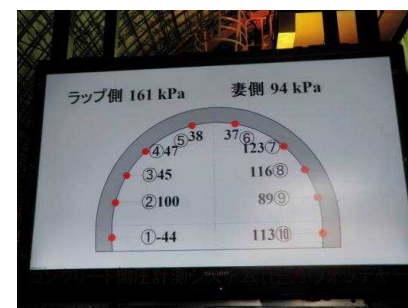
写真-13 圧力表示状況位置
