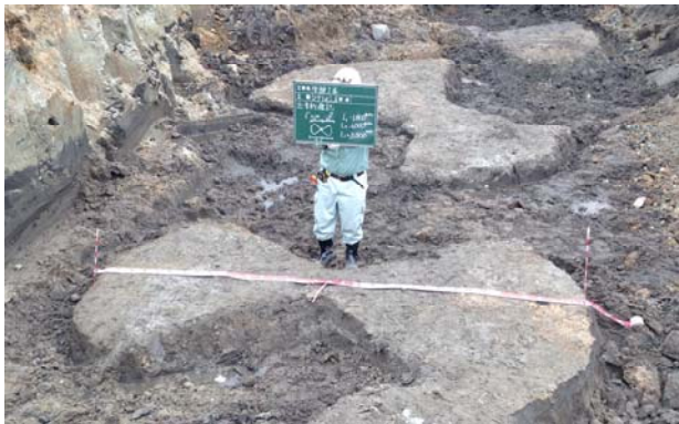
写真－1 改良体発掘全景（扇形，φ 3.6m）
