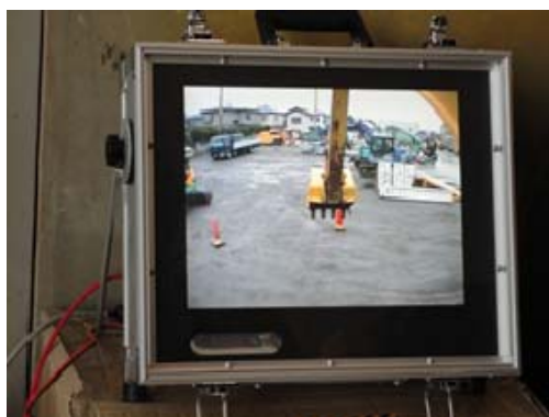
写真—1 重機搭載カメラからの映像
