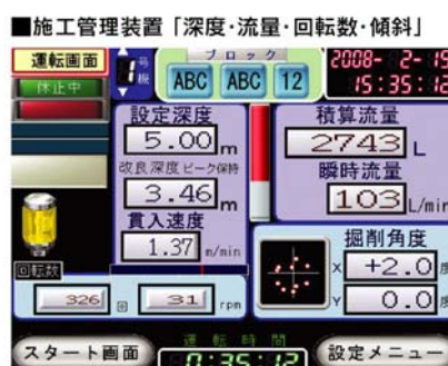
写真－5 リアルタイム管理装置（WILL 工法）
