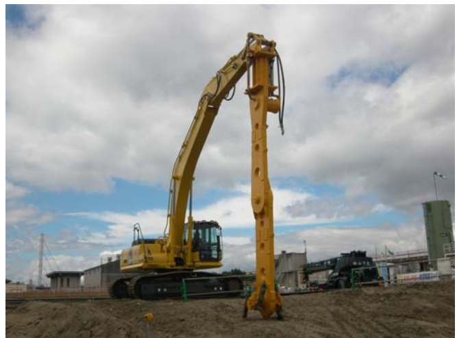
写真－3 WILL 工法地盤改良機（1.4m 3 級）
