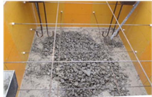
コンクリート殻の締固め混合状況(下層)
