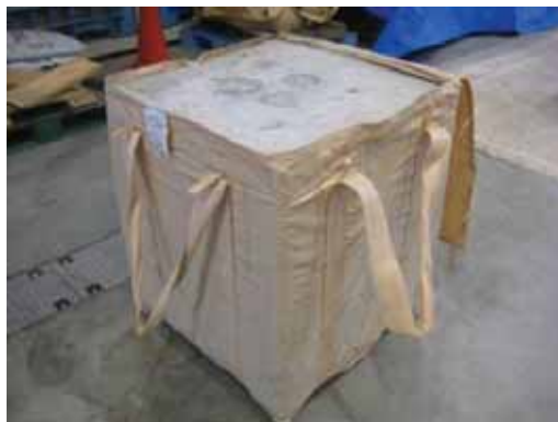
写真-2 アップサイクルブロックの例 (B750×W750×H850mm)
