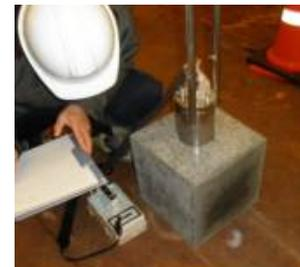
写真－6 放射線量の測定状況
