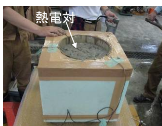
写真-1 供試体作成状況
