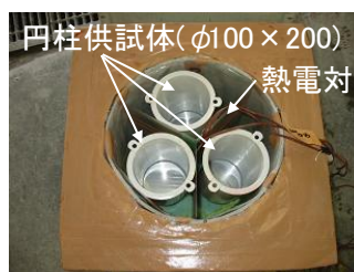
写真-3 型枠設置状況
