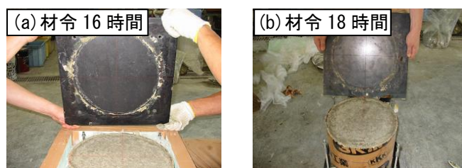
写真-5 剥離性試験結果
