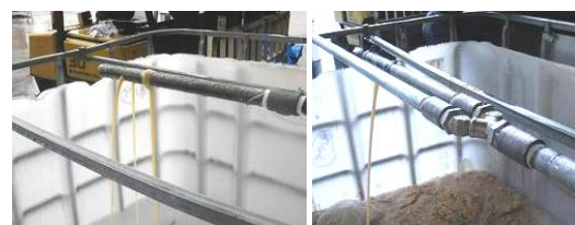
写真－5 薬液吐出試験状況
