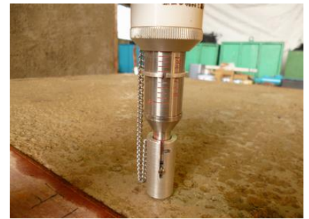
図-4. 針貫入試験による強度確認
