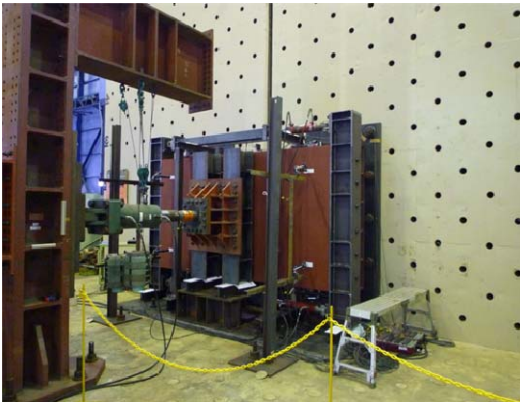
写真-2 実物大継手試験
