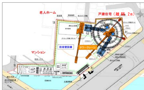
図-8 到達立坑施工ヤード
