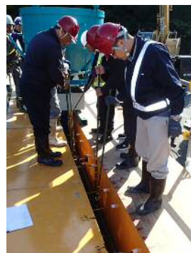
図-7 流動距離と繊維混入割合の確認（試験施工）
