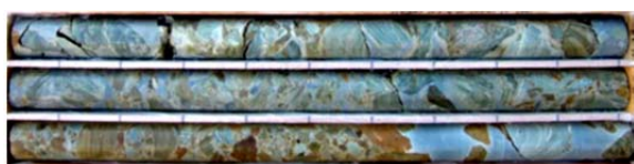
写真-7 改良体ボーリングコアの一例 (0.3D 孔, G.L.-5.8~8.8m)
