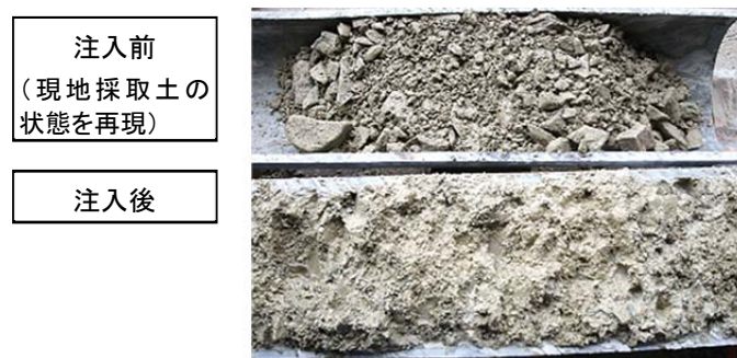
写真-3 可塑性グラウトの充填状況（硬配合）
