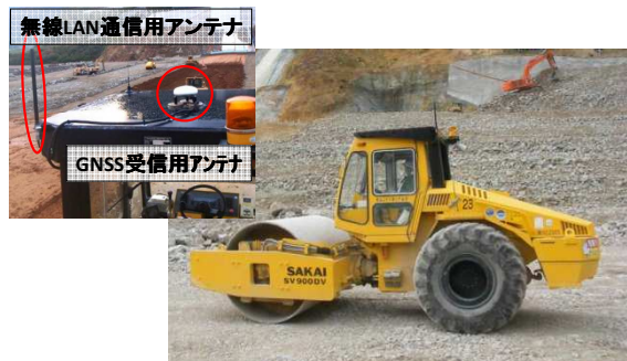
図-6 締固め管理システムの構成
