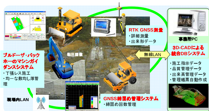
図-1 ICT 土工管理システム概要図
