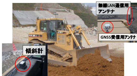
図-10 ブルドーザ MG の構成
