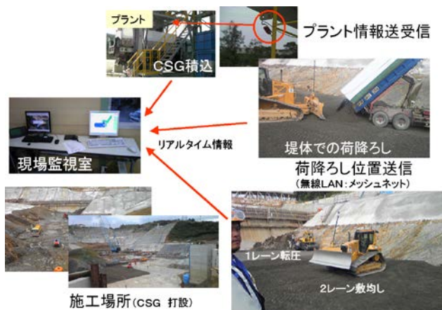
図-11 トレースシステムの運用サイクル
