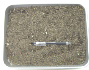
写真－14 津波堆積物の 20mm 以下材
