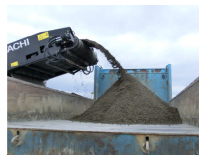
写真-8 津波堆積物の 20mm 以下材
